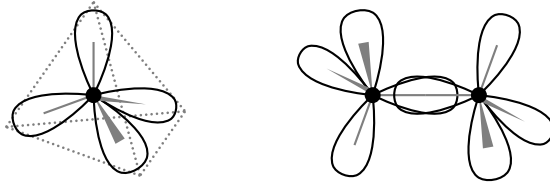
Abbildung 1.4: Skizze: sp^3 hybridisierte Orbitale sowie eine Einfachbindung
