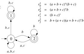
$$L_{\omega}(A) = r_0^1 (r_1^1)^{\omega} + r_0^2 (r_2^2)^{\omega}$$
